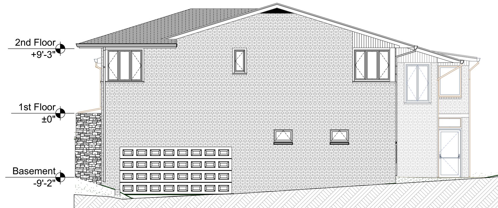
2 SD.5 RIGHT SIDE ELEVATION SCALE: 1/8" = 1'-0"
